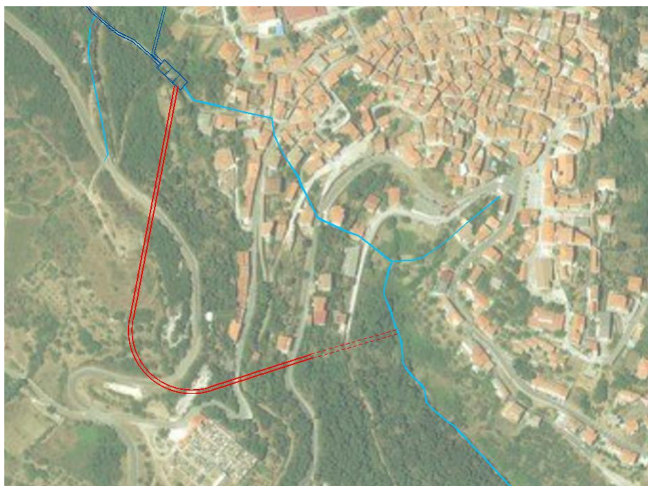
Ipotesi tracciato galleria di bypass (in rosso) e manufatto di restituzione (linea tratteggiata in rosso)
